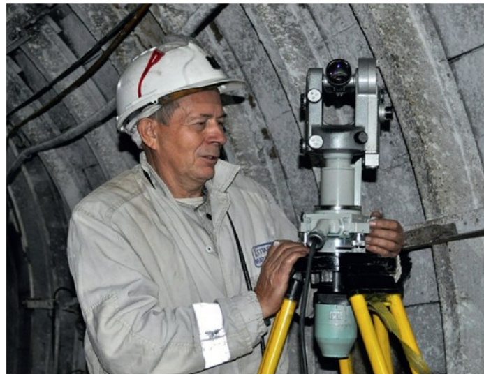
Рис. 3. Филипчук Б. И. с гирокомпасом MBT2 на шахте Полосухинская, г. Новокузнецк (2018 г.)
